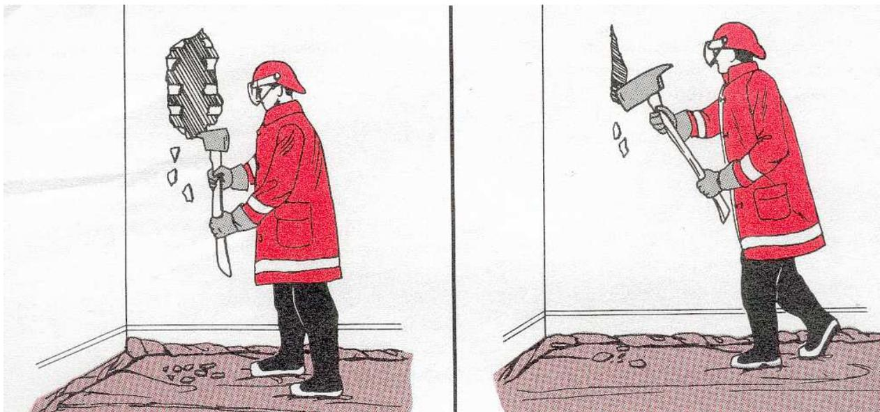
**Figura 18:** Las fajillas de madera y el yeso pueden ser quitados de las divisiones de cuartos con un pico o gancho, mientras un muro de tablaroca puede ser cortado fácilmente a lo largo de sus travesaños.
