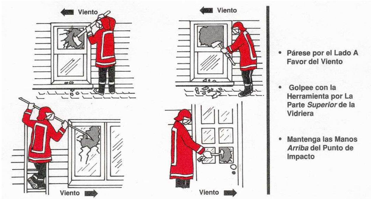
**Figura 11:** Siga todas las precauciones de seguridad, incluyendo la eliminación de todas las piezas de vidrio roto del bastidor, cuando rompa los cristales.
