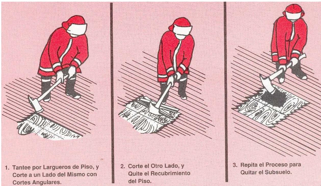
**Figura 17:** Siga estos tres pasos para abrir un piso de madera.
