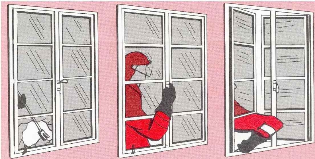
**Figura 15:** Rompa el panel inferior de cristal, desconecte el pestillo y opere el mecanismo para abrir la ventana.
